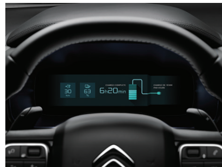
Digitální přístrojový 12,3", displej se zobrazením hybridního režimu
