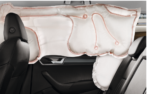
BOČNÍ AIRBAGY Čtyři boční airbagy, dva vpředu a dva vzadu*, jsou určeny k ochraně pánve a hrudníku pasažérů v případě bočního nárazu.
