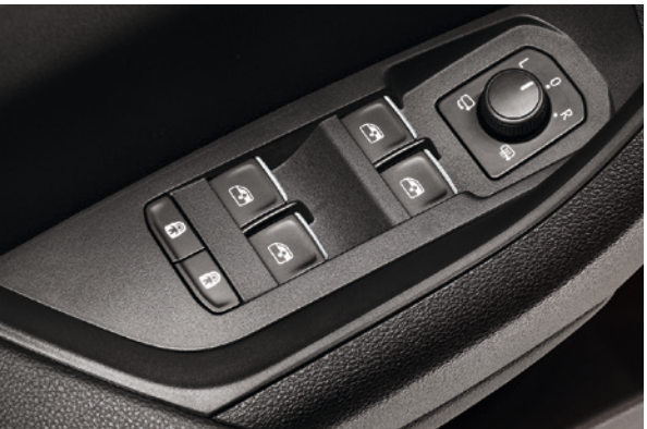
ELEKTRONICKÁ DĚTSKÁ POJISTKA Stačí jednou stisknout tlačítko, a cestování Vašich dětí bude ještě bezpečnější. Dětská pojistka jim zabrání v otvírání zadních oken i dveří.
