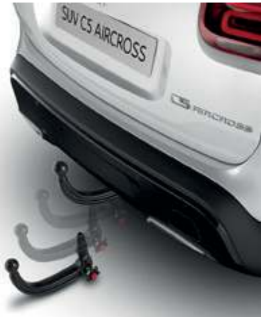
■ Tažné zařízení demontovatelné bez nářadí Kód: 16 380 863 80
