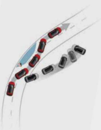
Elektronicky řízený stabilizační systém ESC (Electronic Stability Control) Stabilizační systém ESC pomáhá předcházet smyku vozidla výpočtem správného brzdového tlaku pro každé kolo. Také snižuje výkon motoru, abyste si zachovali kontrolu nad vozem a mohli pokračovat ve zvoleném směru jízdy.
